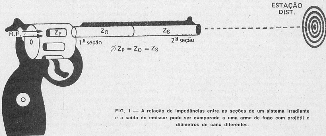
FIG. 1 — A relação de impedâncias entre as seções de um sistema irradiante e a saída do emissor pode ser comparada a uma arma de fogo com projétil e diâmetros de cano diferentes.
